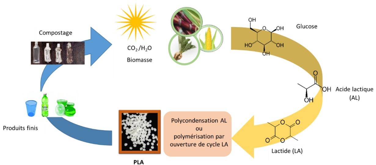
**Figure 4** : Cycle de vie de l'acide polylactique : (1) formation d'acide lactique (AL) par fermentation d'agro-ressources, (2) formation du lactide (LA) par dimérisation-cyclisation de l'AL, (3) formation du polylactide (PLA) par polycondensation de l'AL ou ROP du LA, (4) compostage du PLA et formation de sous-produits biocompatibles.
