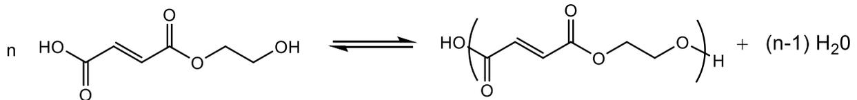
**Figure 7.** Exemple de formation des polyesters insaturés (UP)
