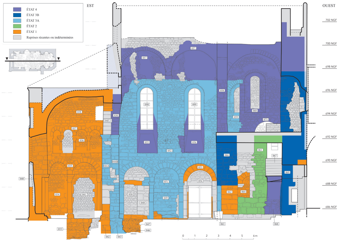
Fig. 1. Baptistère du Puy (Le Puy-en-Velay, Haute-Loire), analyse des différentes étapes de la construction. C. Sapin in: Mérel-Brandenburg 2018, fig. 125, p. 144. © CEM-Auxerre.
