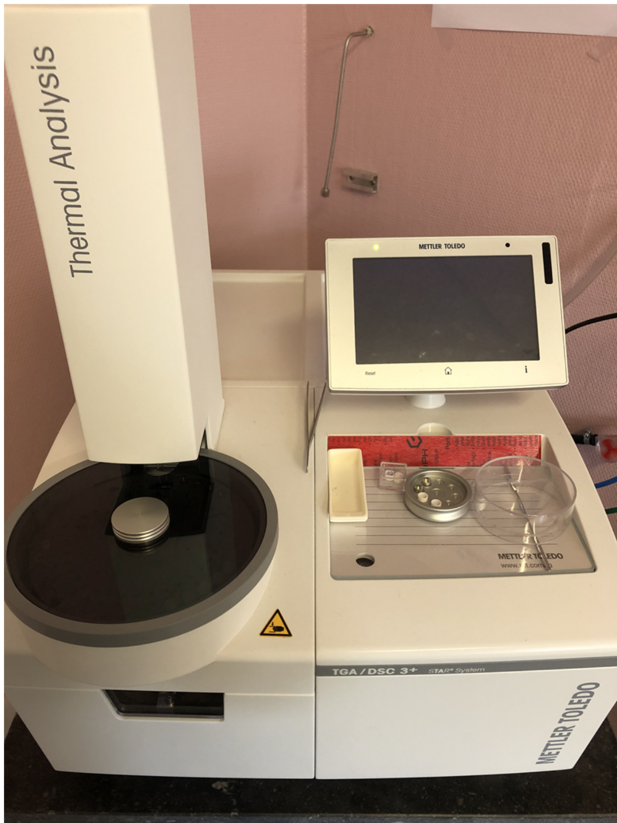
Figure 6. The Mettler-Toledo 3+ instrument used for STA, housed in the Unité de Catalyse et Chimie du Solide at the Université de Lille.
