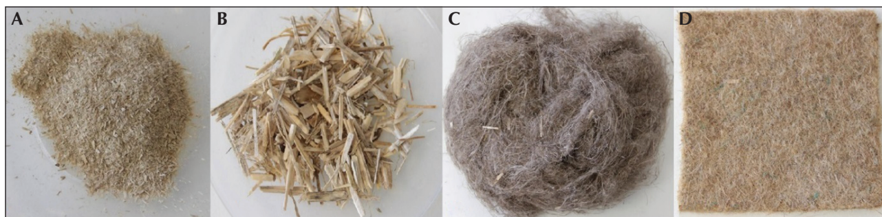
Figure 1. Illustrations de matériaux adsorbants à base chanvre : (A) poudres, (B) copeaux, (C) fibres et (D) feutrine.
