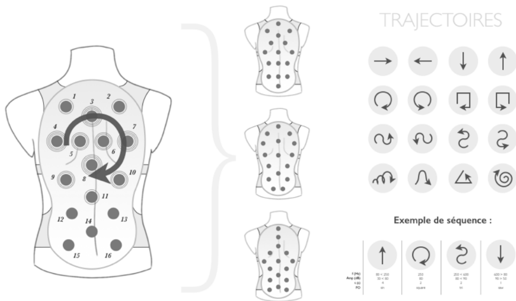
Fig. 1 : Exemple d'intégration du VibSTraM, illustrant plusieurs trajectoires et une séquence de stimuli, à travers un dispositif haptique multicanal et modulaire (16 canaux) de type sac à dos. ©Alban Briceno
