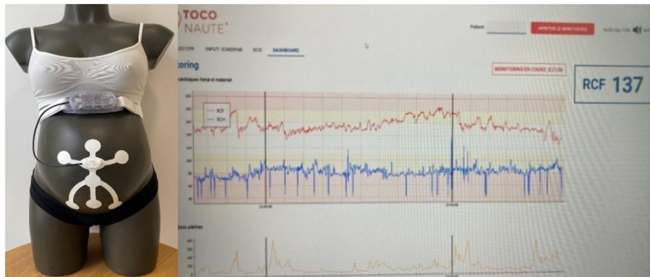
Fig. 5. TOCONAUTE (à gauche). Signaux cardiaques maternels (en bleu) et fœtaux (en rouge). Contractions utérine (en bas de l'écran).
