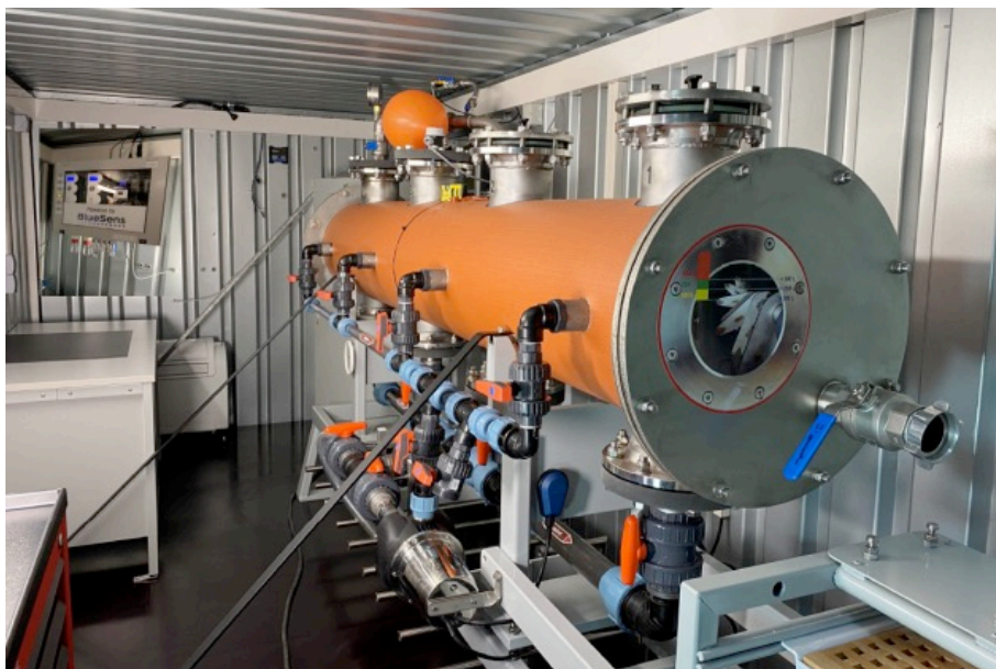
Figure 25 : Exemple de réacteur à piston de faible dimension pour une implantation auprès de petites collectivités. (Photo par Stefan Junne)
